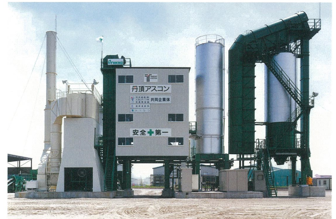
1600型全自動バッチ式アスファルトプラント
