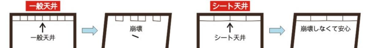
地震時における建物自体の過大な変形が天井材の衝突・落下災害を招きます。
